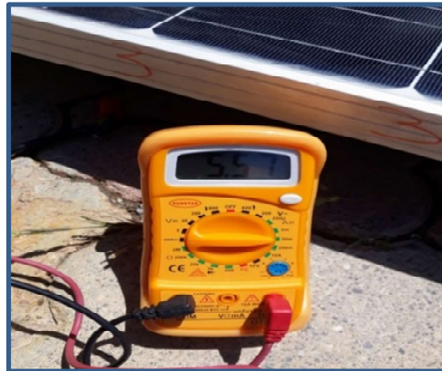
شکل ۷. اندازه‌گیری ولتاژ و جریان با استفاده از مولتی‌متر.
