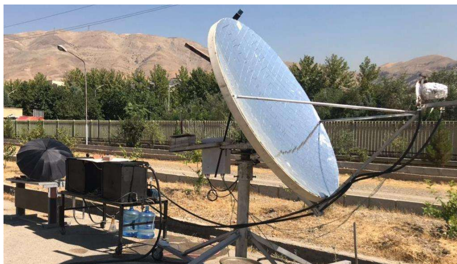
شکل ۳- نمای کلی سامانه نمک زدایی ساخته شده
