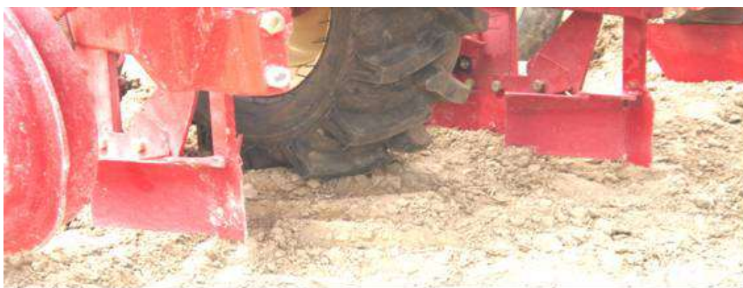
شکل ۲: استفاده از عامل جویچه ساز قبل از شیاربازکن ماشین کاشت جهت ایجاد شیار
