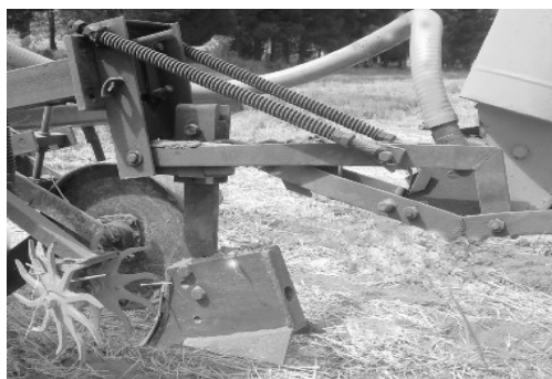
شکل-۲- شیاربازکن چیزل باله دار به همراه ضمیمه ردیف تمیزکن
