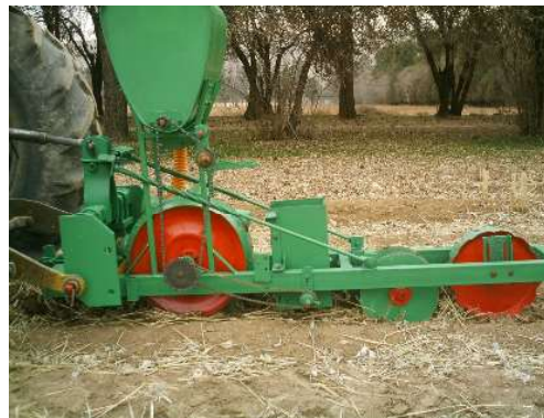
شکل ۱- نمایی از کارنده حفره ساز در حال کاشت
