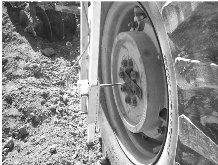
شکل ۲ - دستگاه مبدل شافت انکودر کوبله شده بر روی چرخ تراکتور
