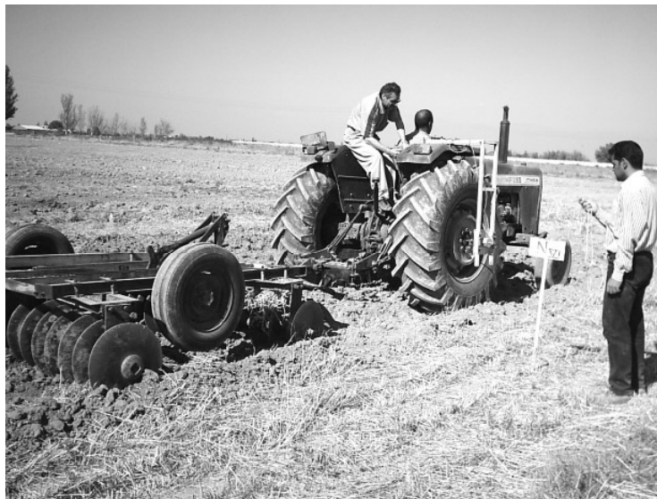
شکل ۱ - اندازه گیری میزان لغزش چرخهای محرک و سرعت واقعی تراکتور
