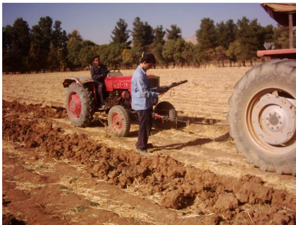
شکل (۹)- روش تست دو تراکتوری در مزرعه
