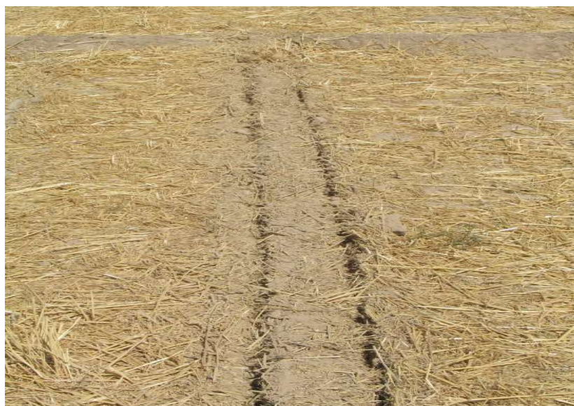
شکل ۳: شیار ایجاد شده توسط شیار باز کن دو تایی در حالتی که چرخشی صفحه برش در خلاف جهت چرخ های تراکتور باشد
