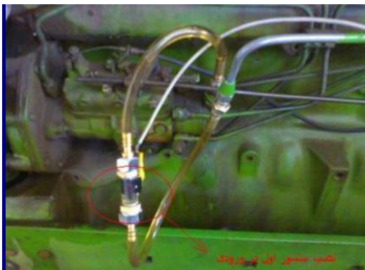
شکل (۱۴): محل نصب سنسور دبی سنج در ورودی سوخت به پمپ انژکتور
