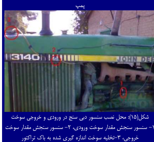
شکل (۱۳): پمپ انژکتور آسیابای تراکتور جاندر ۳۱۴۰ و محل ورود سوخت به
