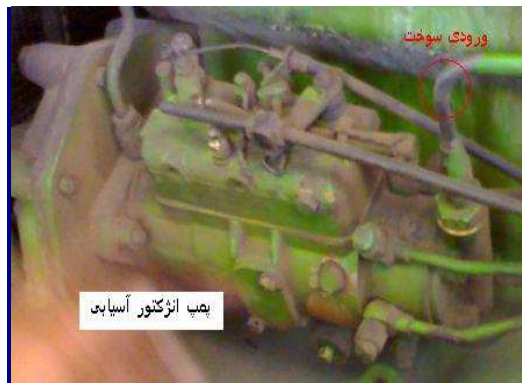
شکل (۱۳): پمپ انژکتور آسیابای تراکتور جاندر ۳۱۴۰ و محل ورود سوخت به
