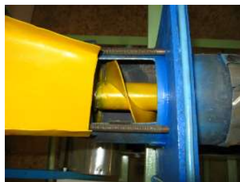
شکل ۵) استوانه باردارکننده و هلیس گردان (سمت راست) و نمای کلی دستگاه (سمت چپ)
