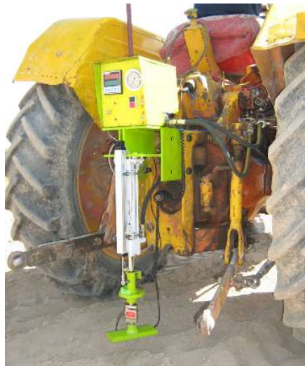
شکل ۲. دستگاه بوامتر پشت تراکتوری نصب شده بر روی تراکتور.
