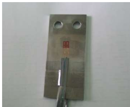
شکل شماره ۱ - لودسل تیری یک سر گیردار و پل وتسون برای اندازه گیری نیرو
