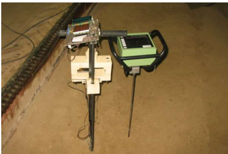
شکل ۴- دستگاه ساخته شده (چپ) و نوع تجاری (راست) در مخزن خاک
