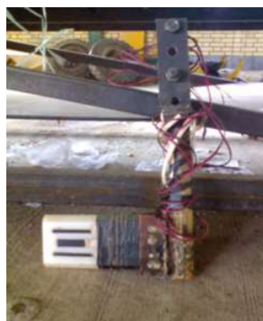
شکل ۵- تصویر واقعی از حسگر اندازه‌گیر رطوبت خاک در حالی که در گیره نگه‌دارنده ثابت شده است.
