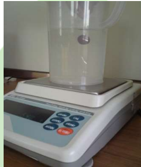
شکل ۴. سیستم اندازه‌گیری حجم جابه‌جا شده
