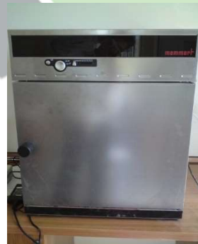
شکل ۲. گرمخانه یا اوون مورد استفاده برای تعیین درصد رطوبت آلوچه
