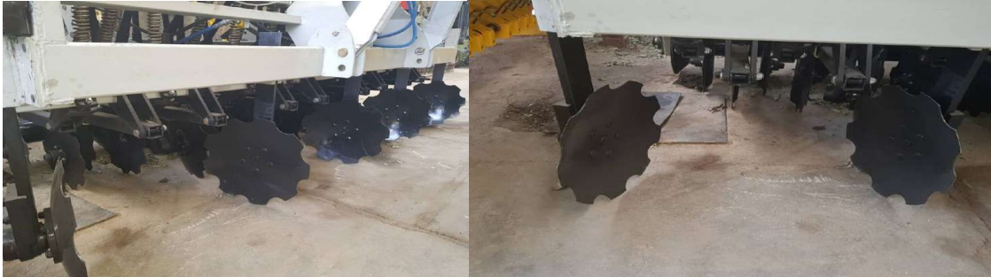
شکل ۳- بشقاب دستگاه و نحوه استقرار آن
