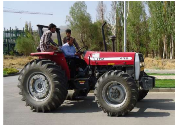
شکل ۳. اندازه‌گیری ارتعاش صندلی تراکتور مورد بررسی حین حرکت بر روی جاده آسفالت (راست) و خاکی (چپ).
