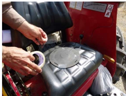
شکل ۲. اتصال حسگر ارتعاش سنج به صندلی تراکتور مورد بررسی.
