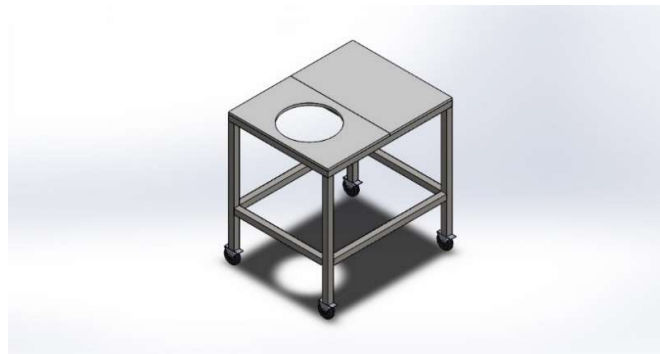
شکل ۱. مدل شاسی طراحی شده در نرم‌افزار سالی‌دورکس
