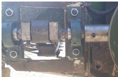
شکل ۳-۴- اتصال میل لنگ به شاسی
