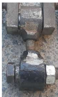
شکل ۳-۵- شاتون با دو مفصل متحرک
