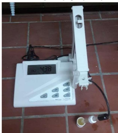
شکل ۳: pH متر مدل BP300
