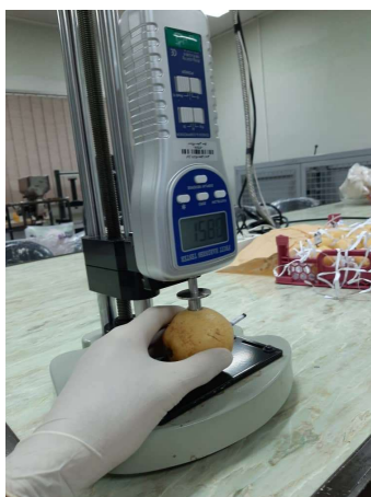
شکل ۱: نحوه اندازه‌گیری سفتی میوه گلابی
