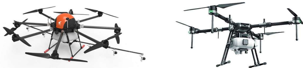
شکل 1. راست: پهپاد سمپاش با آرایش نازل ها در زیر موتور ها، چپ: پهپاد سمپاش با آرایش نازل ها به صورت خطی.
