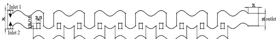
شکل ۵: هندسه میکرومخلوط کننده از ترکیب دیواره مارپیچ و SAR با گذرگاه باریک (هندسه ۵)
