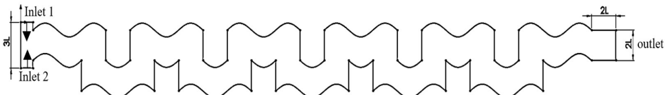
شکل ۴: هندسه میکرومخلوط کننده با دیواره‌های مارپیچ (هندسه ۴)
