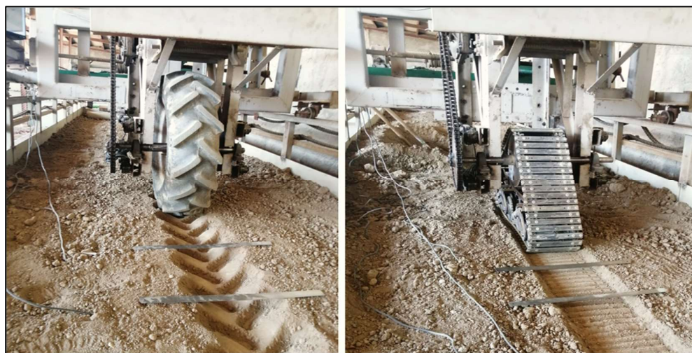
شکل ۲- آزمونگر تک‌چرخ شنی، تک‌چرخ بادی و انباره خاک مورد استفاده در آزمون‌های تجربی.
