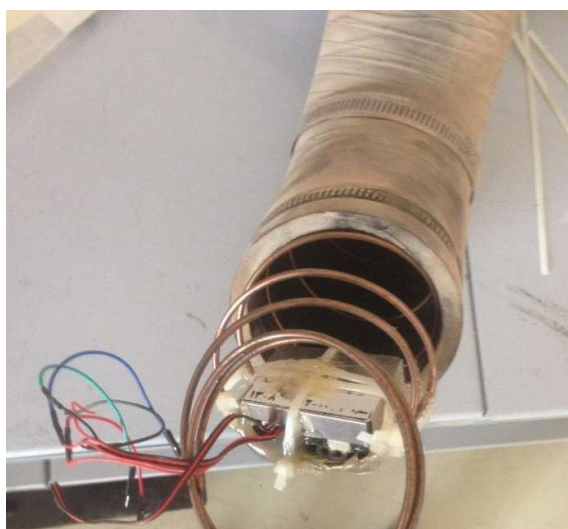
محل قرارگیری حسگر ساخته شده در مسیر هوا به موتور
