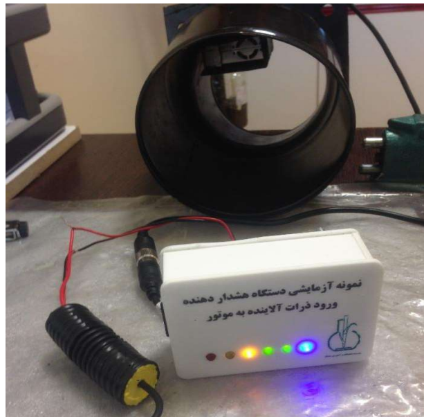
دستگاه نهایی ساخته شده با حسگر IR و ذخیره داده‌ها
