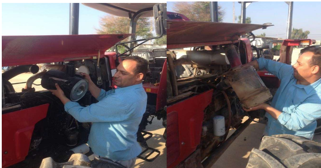
هواکش کاغذی سمت راست و هواکش روغنی سمت چپ تصویر روی تراکتور ۳۹۹
