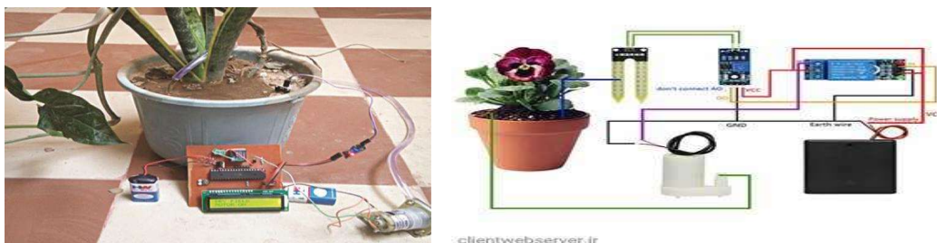
شکل (۴) ساختار کلی ونهایی آبیاری هوشمند گیاهان
