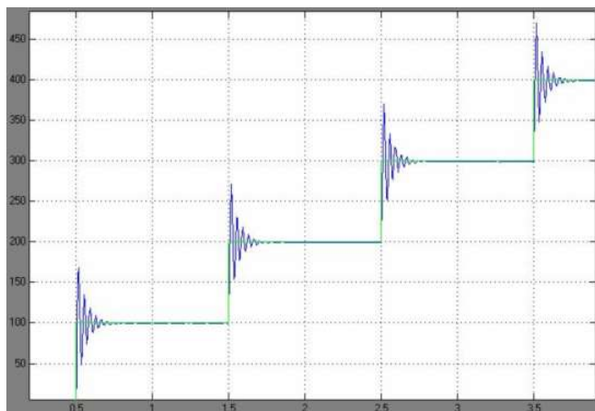
شکل ۶- گرافی از ورودی های چند حالتی به طور پیوسته از ۰ تا ۲۳۰۰ rpm و نتیجه شبیه سازی آن ها
