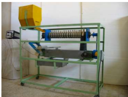
شکل ۱) جداکننده الکتروستاتیکی مورد استفاده
