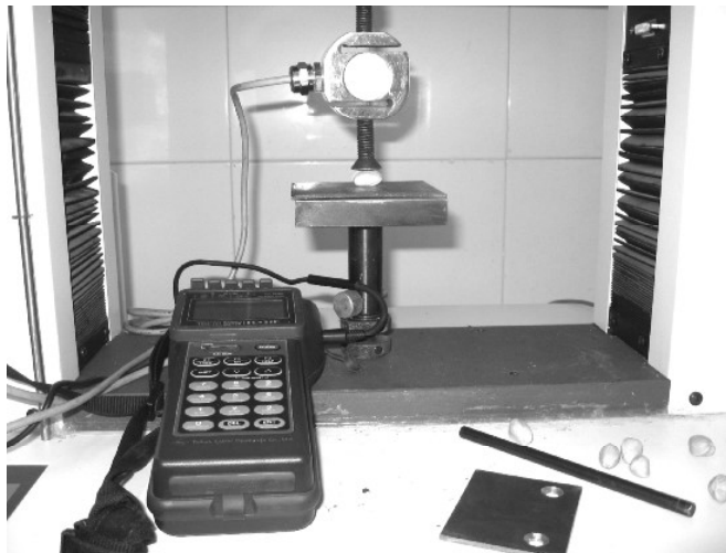
شکل ۳: دستگاه تهیه شده به منظور اندازه‌گیری مشخصه‌های مربوط به آزمایش استراحت تنش
