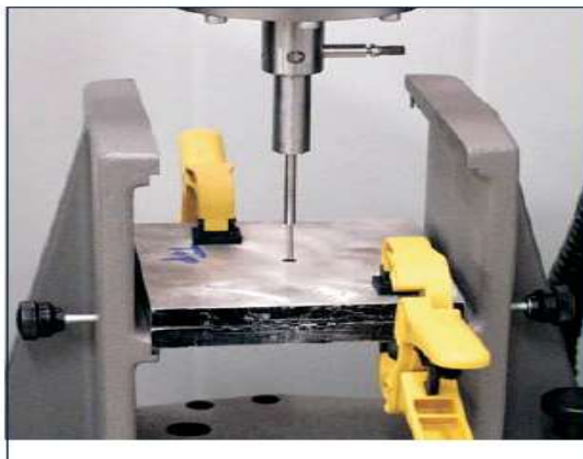
شکل ۲. نحوه اتصال صفحات در برگرفته روده مرغ به دستگاه کشش-فشار (شکل شماتیک و تصویر واقعی آن).
