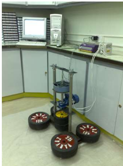
شکل ۳- نمایی از تجهیزات اندازه گیری ضریب اصطکاک دینامیکی و نحوه ارتباط اجزا
