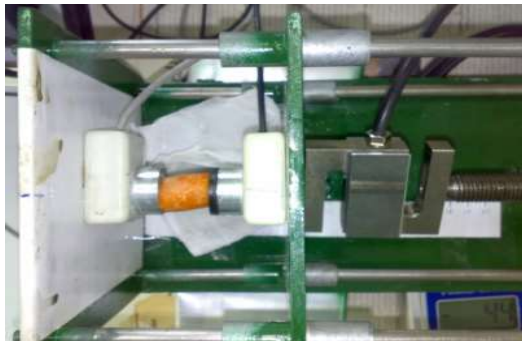
شکل ۳- نحوه قرارگیری نمونه بین کاوشگر فرستنده و گیرنده، نمونه‌ی هویج، ضخامت 24/6 \text{ mm} و نیروی تماسی 0.5 \text{ N} .
