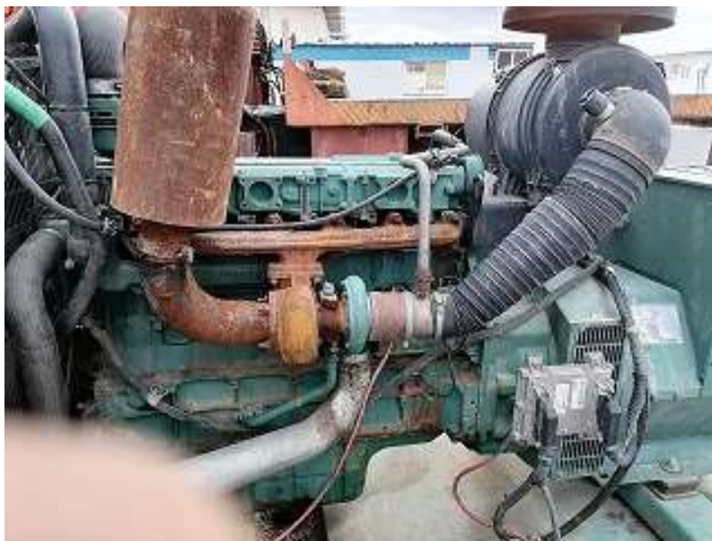
شکل ۴- نمای کامل موتور مجهز به ecu
