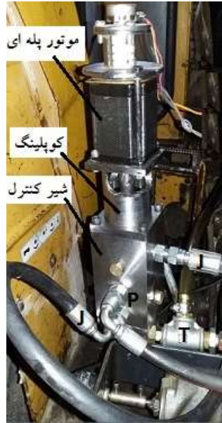
شکل ۵- شیر کنترل الکترونیکی نصب شده در روی تراکتور
