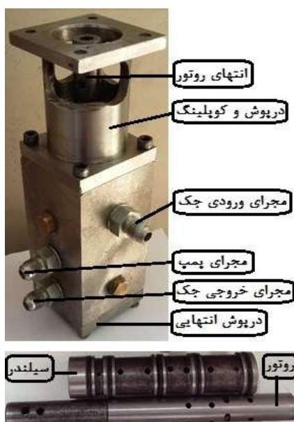
شکل ۴- اجزای شیر کنترل جدید (الکترونیکی)
