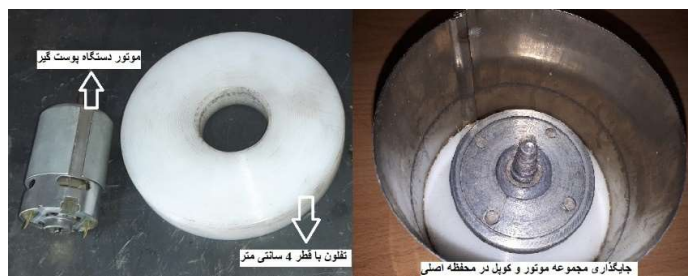
شکل ۳. قرارگیری مجموعه موتور و کوپل در محفظه اصلی دستگاه
