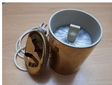
شکل ۱. طرح اولیه پوست‌گیر سیر در محیط کتیا شکل ۲. نمونه ساخته شده کارگاهی پوست‌گیر سیر
