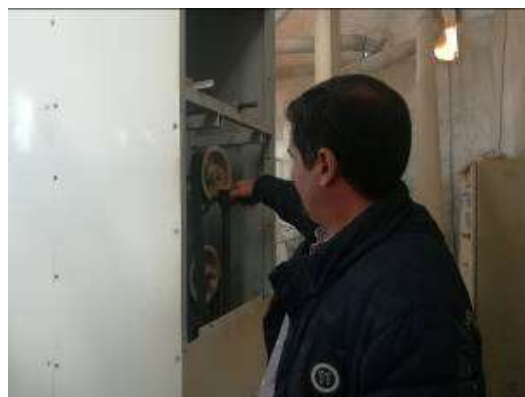
شکل ۵- استفاده از دورسنج نوری برای تعیین سرعت دورانی محور ماشین
