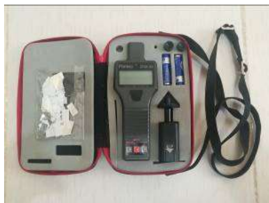
شکل ۴- دورسنج نوری مدل Pantec DTM 30
