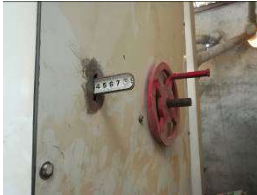
شکل ۲- تیغه متصل به دریچه ورودی ماشین و چرخ و فلکه تنظیم آن
