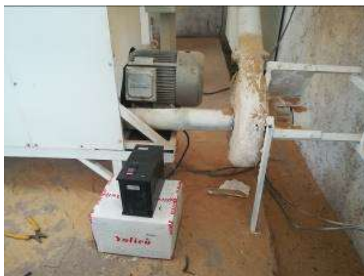
شکل ۳- الکتروموتور و اینورتر سه فاز ۱۱ کیلووات نصب شده روی ماشین لایه بردار
