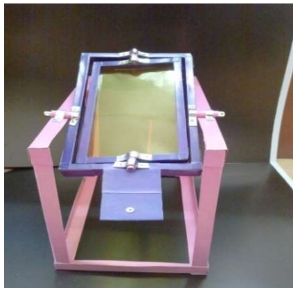
شکل ۳- ماکت دستگاه متمرکزکننده خورشیدی مجهز به لنز فرسنل خطی در مقیاس ۱/۱۰
