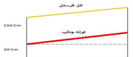
شکل ۲- ابعاد پایه های دستگاه متمرکز کننده لنز فرستل خطی
