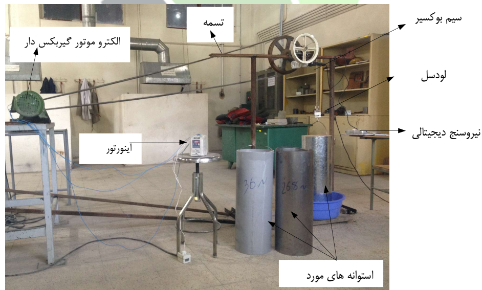
شکل ۱- تجهیزات مورد استفاده برای اندازه گیری نیروهای نرمال و جانبی از طرف توده دانه
