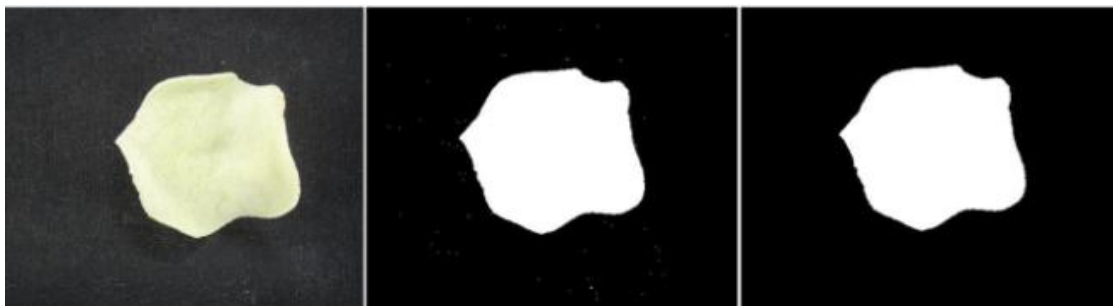
شکل ۴- تصویر اصلی و باینری شده ورقه سیب‌زمینی پس از اعمال آستانه و کاهش نویز
