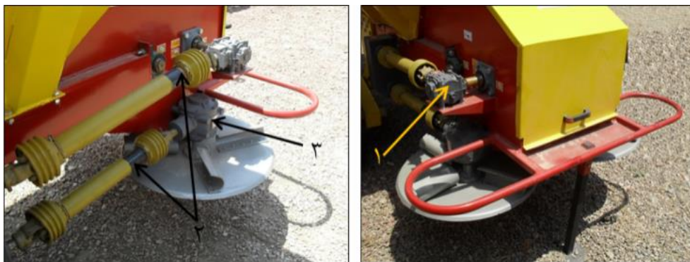
شکل ۳- سیستم انتقال توان. (۱) گیربکس زنجیرنقاله، (۲) میل‌گاردان، (۳) گیربکس حلزونی صفحه کودپران
