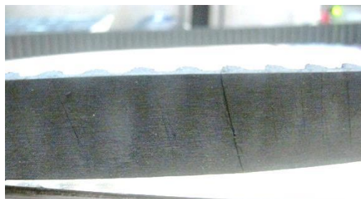
شکل ۳- ترک در پشت تسمه زمانبندی
