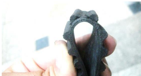
شکل ۴- جدایش دندان تسمه زمانبندی از ریشه آن
