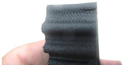
شکل ۲- ترک روی دندان تسمه زمانبندی
