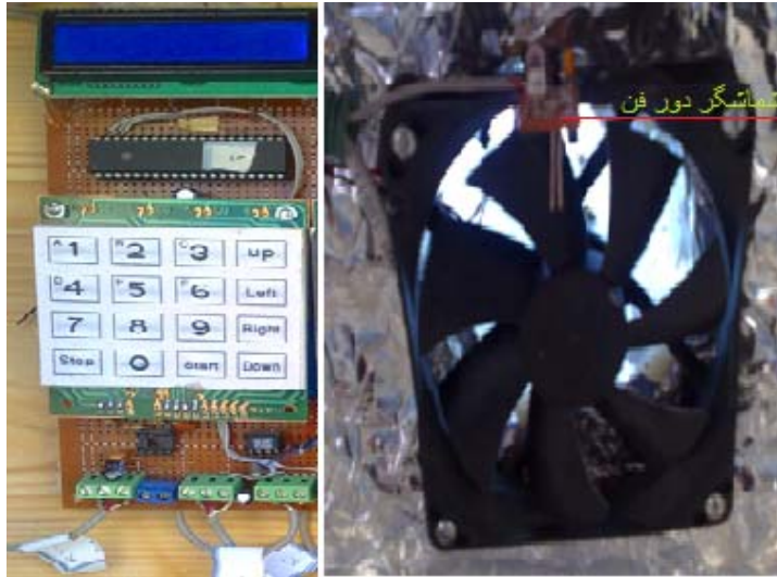
شکل ۲- سیستم کنترل جمع کننده انرژی خورشیدی
