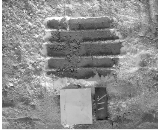
شکل ۸: اثر چرخ بر روی خاک به همراه شاخص و پلاک شماره گذاری
