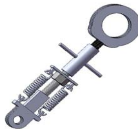
شکل ۵- طرح بازوی شناور هد بردارنده غلتکی.
