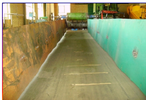
شکل ۶- کانال ایجاد شده بر روی تست ریگ برای جلوگیری از حرکت جانبی بقایا.
