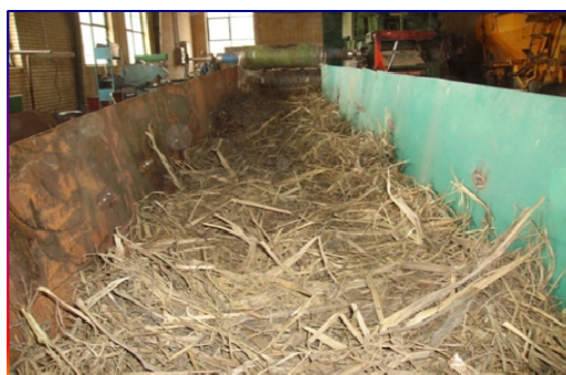
شکل ۶- کانال ایجاد شده بر روی تست ریگ برای جلوگیری از حرکت جانبی بقایا.
