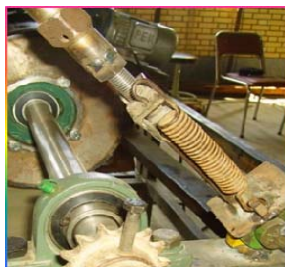
شکل ۵- طرح بازوی شناور هد بردارنده غلتکی.
