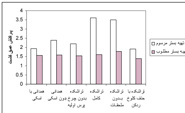
نمودار ۲- پراکنش عمق کاشت بذر حول عمق تنظیم شده (۵ میلی متر)
