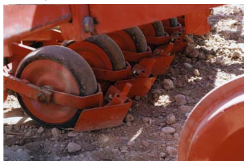
شکل ۱- کلوخ ردکنها و چرخهای پرس اولیه در ردیفکار تراشکده
