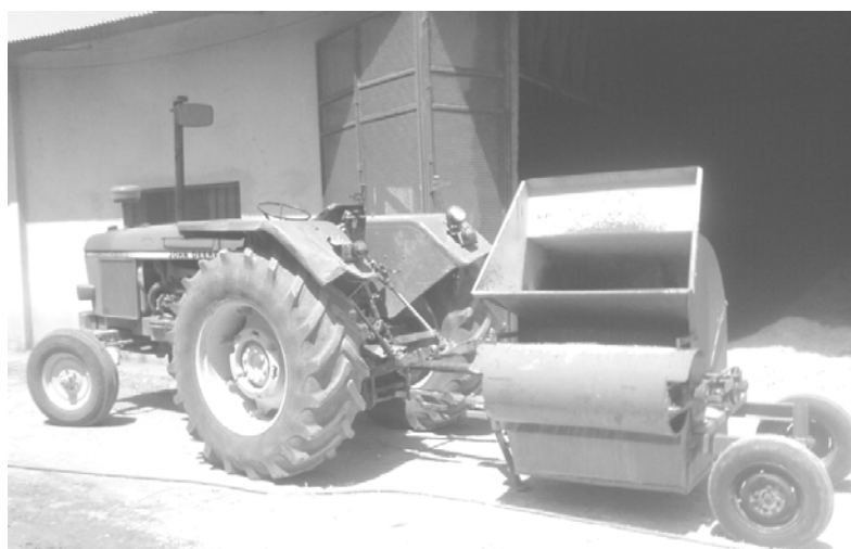
شکل ۳-آزمایش تعیین دور کوبنده چابر کششی
