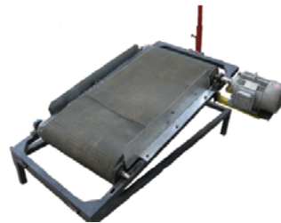
شکل ۳: نمونه آزمایشگاهی مکانیزم جداکننده سنگ و کلوخ از سیب‌زمینی (نوع تسمه‌نقاله‌ای)
