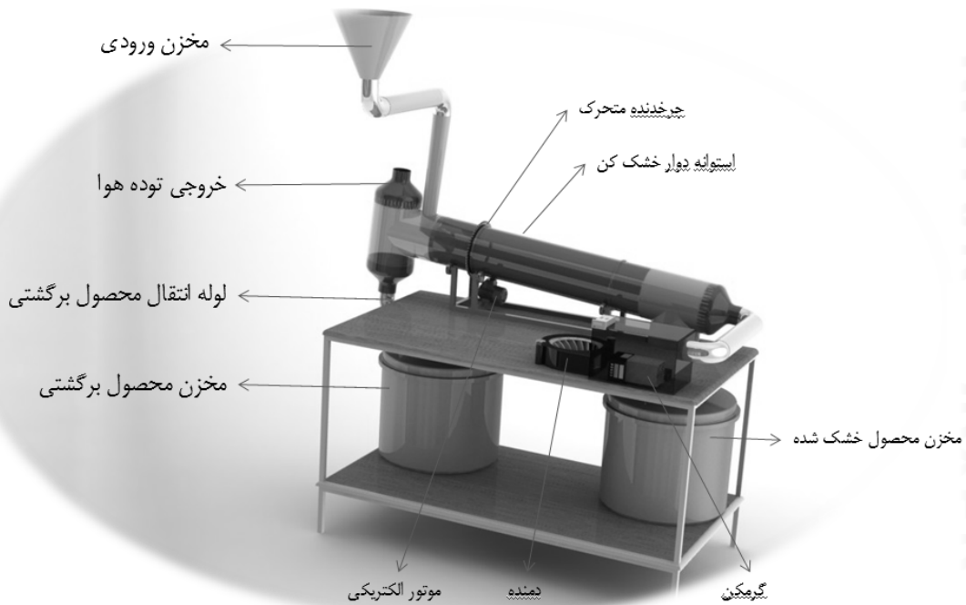
شکل (۱) اجزای یک خشک کن چرخشی با سیکل بسته (مدل طراحی شده با نرم افزار solidworks 2010).
