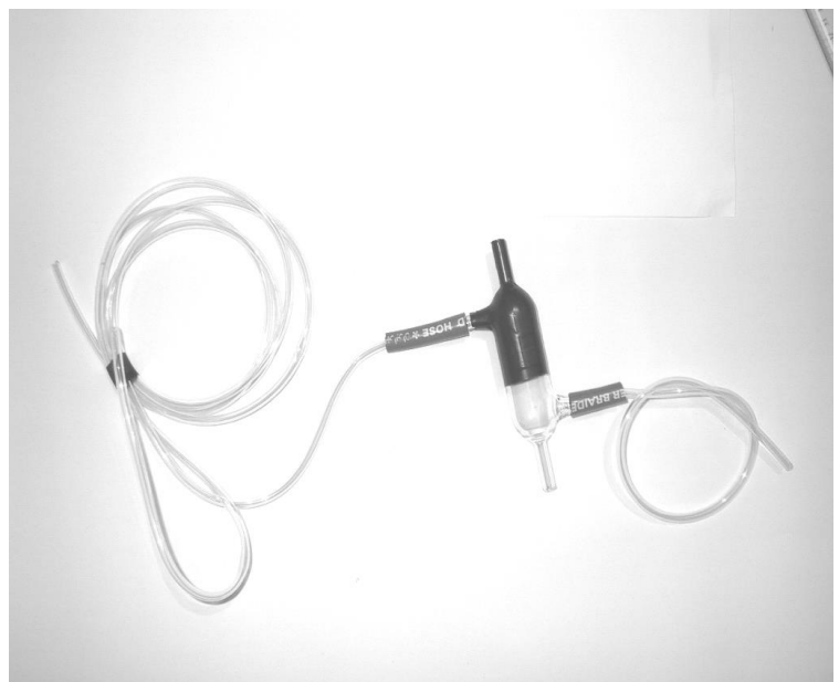
شکل ۳ : تیوب با چهار مجری (دو خروجی برای قرارگیری سنسورها و دو مجری برای ورود و خروج دود)
