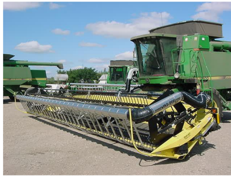
شکل ۵ - کمباین جاندر مجز به واحد تغذیه کننده پنو ماتیگ جهت برداشت مکانیزه سویا
