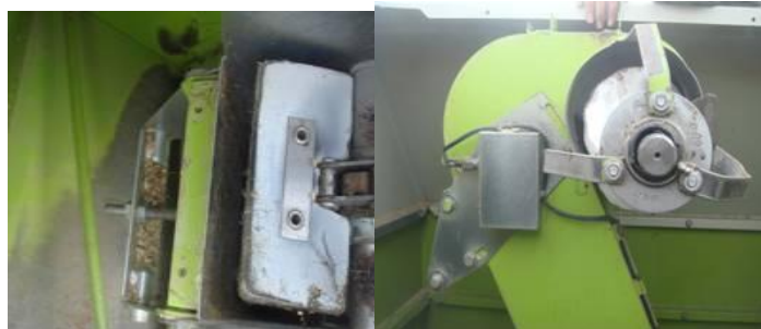
شکل 2 - محل نصب دستگاه اندازه گیر دبی روی الواتور گندم تمیز
