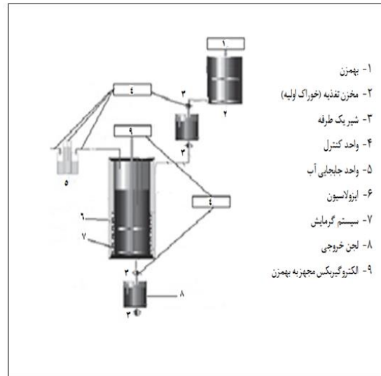
شکل ۱- شماتیک هاضم نیمه پیوسته
